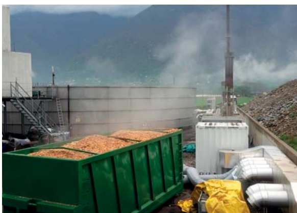
Essiccazione cippato con calore residuo cogenerazione a biogas (Cadenazzo)
